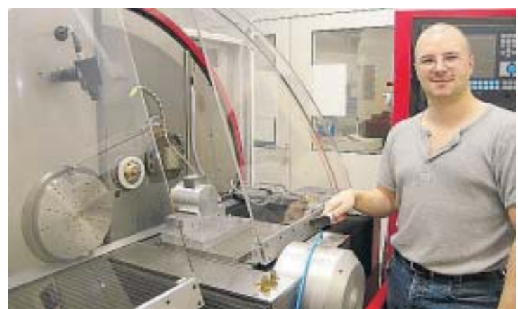
Die Ultrapräzisionsfräse ist das Herzstück. Geschützt durch eine Schleuse sind Temperatur und Luftfeuchte exakt geregelt. Getragen von einem Granitblock, der auf einem eigenen Fundament sitzt, ist sie frei von Erschütterungen.
