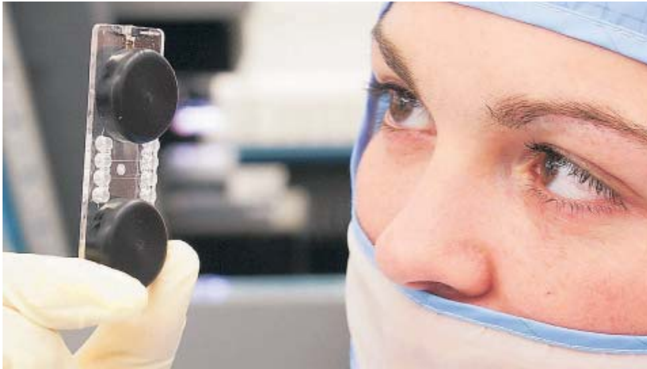
Der Doppelpumpenchip, den die Ingenieurin in ihrer Hand hält, ist eine Komponente des mikrofluidischen Baukastens der thinXXS Microtechnology AG. Fotos: Elisabeth Beduhn/thinXXS
