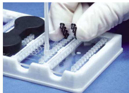
Abb. 2: Chip-zu-Chip-Fluidverbinder und Schlauchanschlüsse sorgen für fluidische Ankopplung der Chips untereinander und an die Laborumgebung.
